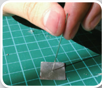
圖 2. 鋁片戳針孔示意圖
