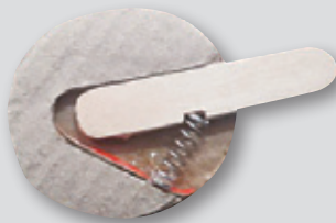
圖 15. 彈簧鏡頭蓋（上），彈簧鏡頭蓋特寫（下）
