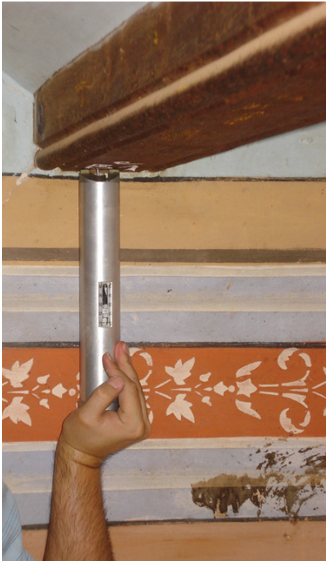
Figura 1. Empleo del penetrómetro Pilodyn 6J.
