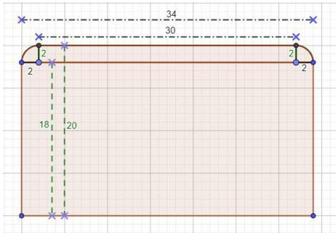
Da die Breite von 18 m auf 20 m vergrößert werden soll und die Länge der nicht-gebogenen neugestalteten Fassade von 34 m auf 30 m gekürzt werden soll, müssen die Platten mit einem Radius von 2 m gebogen werden (siehe Abbildung).
